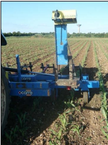
Oeil optique installé sur la bineuse
